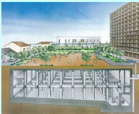
高辻雨水滞水池
