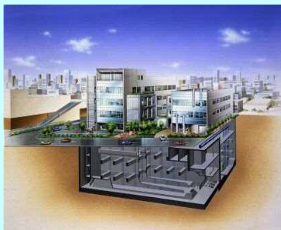
福江雨水滞水池
