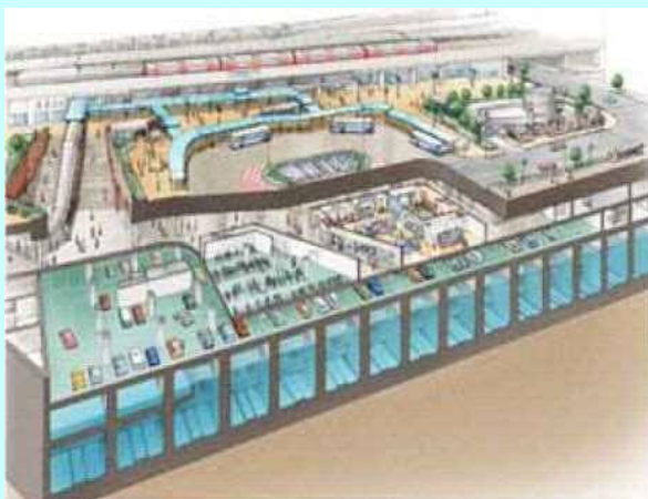
大曽根雨水調整池
