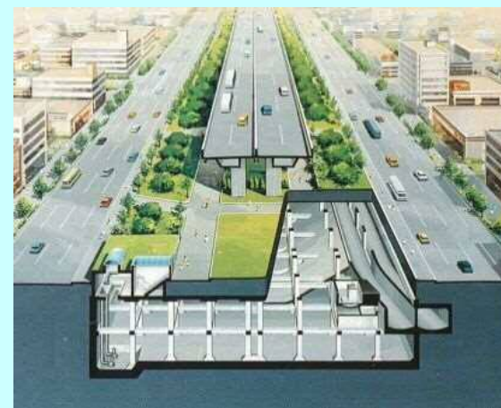
若宮大通調節池内 合流対策施設
