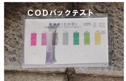
CODパケットテストの結果は、公定法の結果より大きめの値でした。水質の変化の傾向はとらえられています。
